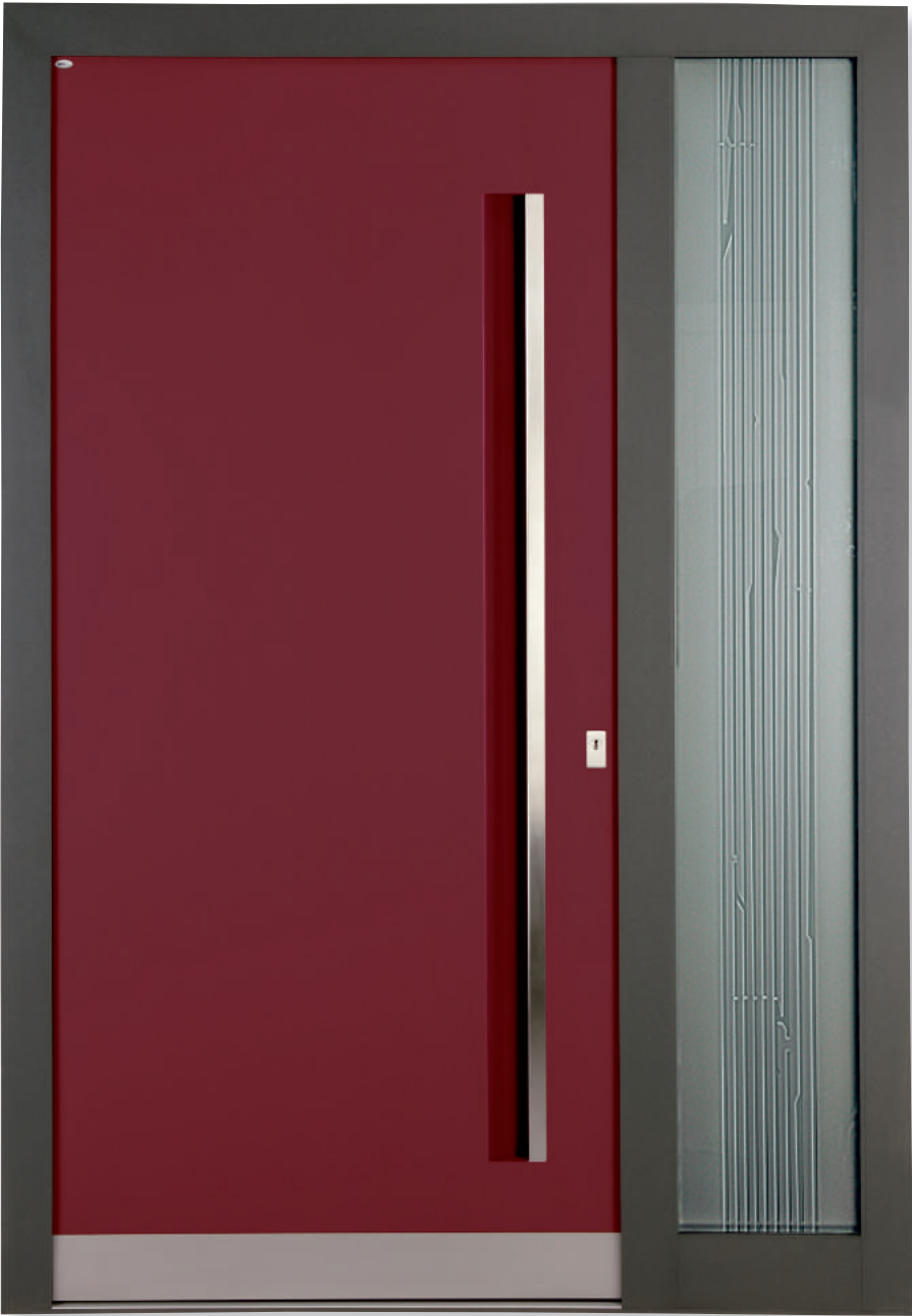
LA 10 flügelüberdeckend Farbe: Türrahmen ST 703 dunkelgrau Türfüllung ST. 3004 purpurrot mit Edelstahlsockelblech flächenbündig Grifftasche: H 95 I (1600 mm) Seitenteilverglasung: Reliefgestaltung mit 3-D Mattierung Preisgruppe: I I.2 (nur mit 3-fach Glas möglich)
